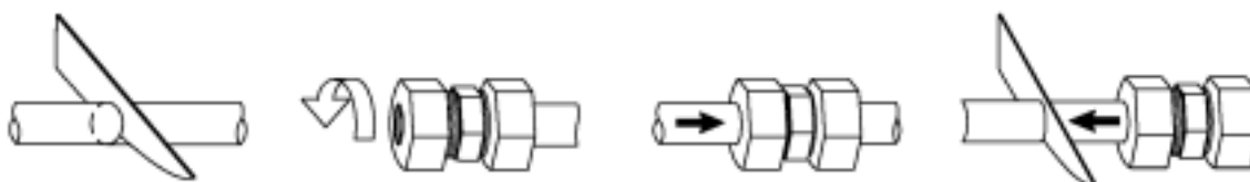
图 13 收缩装置的连接
